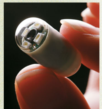
▲「膠囊內視鏡」長 2.6 毫米，直徑 11 毫米，前端裝有微型鏡頭。
