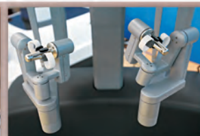
▲ 控制台的手掣，可以控制機械臂作多角度的手術動作。
