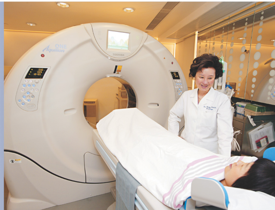
▲新掃描儀旋轉一圈只需0.35秒，就能掃描整個心臟。
