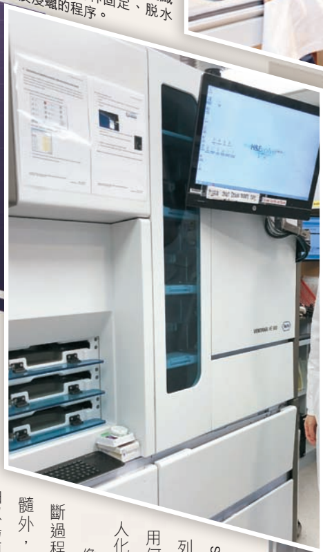
▼組織處理機 (tissue processor)，用以把組織進行福爾馬林固定、脫水及浸蠟的程序。
