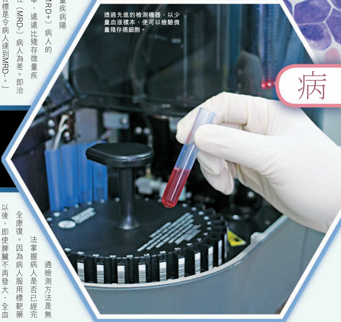
血液樣本會置入數碼液滴聚合酶鏈式反應測試容器，然後由儀器自動運作檢測。
