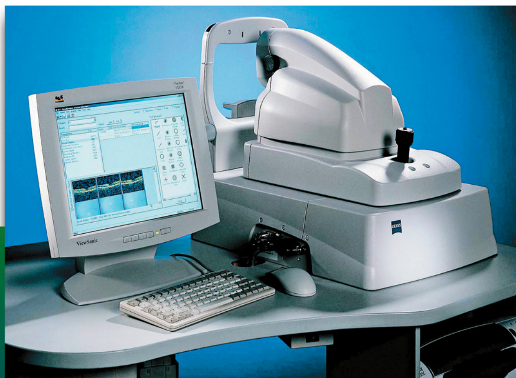
▲利用光相干性斷層造影儀(OCT)，可以檢測出黃斑點有否破損、穿窿或其他結構問題。
