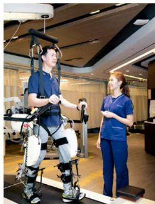
7. **Lokomat機械人步態訓練系統**，能改善腦神經受損的病者，如中風人士的步行方式及速度。
